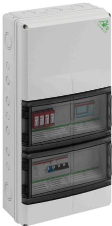
E-Mobility-Infrastrukturverteiler, 2-reihig mit integrierten Belüftungselementen zur Vermeidung von Kondenswasser, bauartgeprüft nach EN 61439-3, anschlussfertig verdrahtet auf Zu- und Abgangsklemmen 10mm<sup>2</sup>
