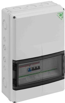
E-Mobility-Infrastrukturverteiler, 1-reihig mit integrierten Belüftungselementen zur Vermeidung von Kondenswasser, bauartgeprüft nach EN 61439-3, anschlussfertig verdrahtet auf Zu- und Abgangsklemmen 10mm<sup>2</sup>
